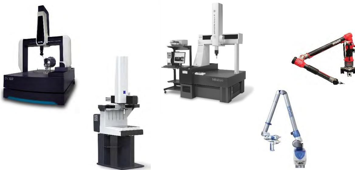
Для контроля геометрии деталей, в зависимости от их размеров и точности измерений, используются различные типы измерительных приборов и машин, такие, как видеоизмерительные микроскопы, координатно-измерительные машины, измерительные руки и другие устройства.
