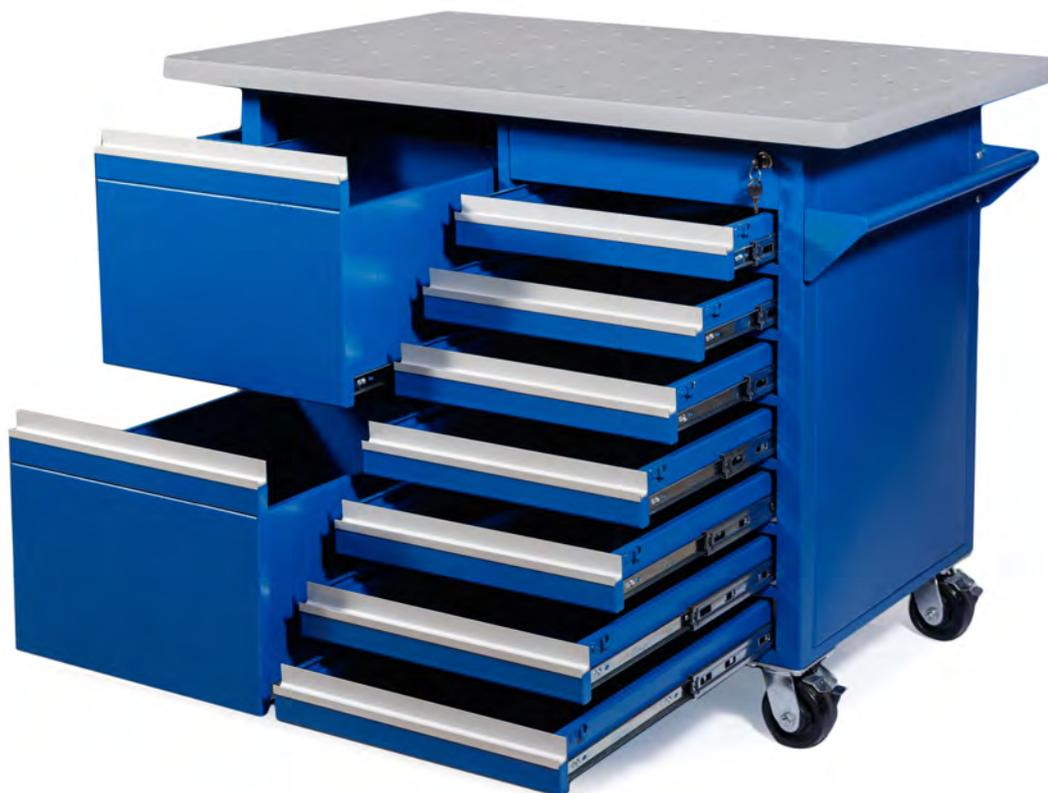
Станция используется для хранения элементов VECTOR, сборки и перемещения внутри измерительного помещения. Поверхность рабочей станции выполнена с высокой точностью из единого листа высокопрочного сплава алюминия размером 1200x750 мм и покрыта защитным бесцветным анодом. Также на поверхности плиты расположена сетка резьбовых отверстий М6 с шагом 100 мм для крепления элементов VECTOR.
